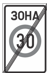
III-27.1 Završetak zone "30"
