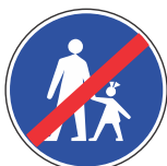
III-20 Završetak staze za pešake
