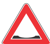
I-9 Neravan kolovoz (ulegnuće)
