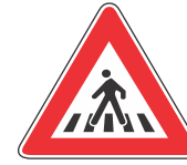
I-14 Nailazak na pešački prelaz
