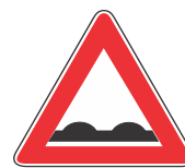
I-8 Neravan kolovoz (opasne izbočine i ulegnuća)
