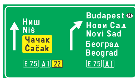
III-211 Pretputokazna tabla za razdvajanje dva autoputa
